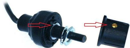
Unter der M10-Montagemutter befindet sich ein Nasenring, mit dem die Anzahl der Drehstellungen mechanisch verriegelt werden kann. Die Nase muß dabei entsprechend der auf dem Gehäuse eingprägten Nummer so in eine Nute eingelegt sein, wie der Schalter mechanische Drehstellungen haben soll. Es empfiehlt sich, den Nasenring vor der Verschraubung des Schalters mit einem Tropfen Silikon- oder Haushaltskleber zu fixieren.
