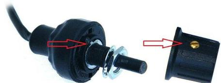
Unter der M10-Montagemutter befindet sich ein Nasenring, mit dem die Anzahl der Drehstellungen mechanisch verriegelt werden kann. Die Nase muß dabei entsprechend der auf dem Gehäuse eingepprägten Nummer so in eine Nute eingelegt sein, wie der Schalter mechanische Drehstellungen haben soll. Es empfiehlt sich, den Nasenring vor der Verschraubung des Schalters mit einem Tropfen Silikon- oder Haushaltskleber zu fixieren.
